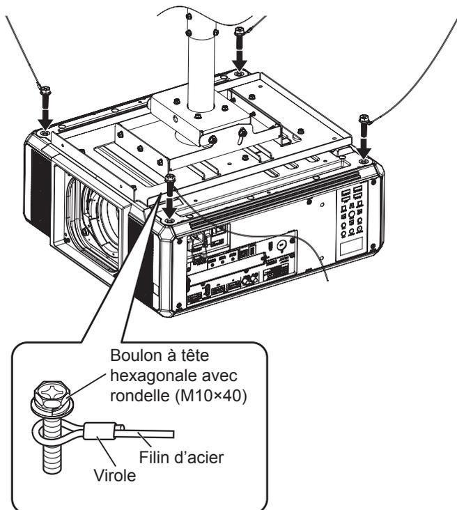
2) Comme indiqué sur la figure à gauche, passez les boulons à tête hexagonale avec rondelles (M10 × 40) fournis par les anneaux du filin d'acier fourni, et serrez les boulons sur les orifices filetés dans lesquels les pieds ajustables ont été préalablement fixés.
